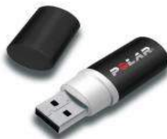
Рисунок 3. – Инфракрасный адаптер IrDA USB
