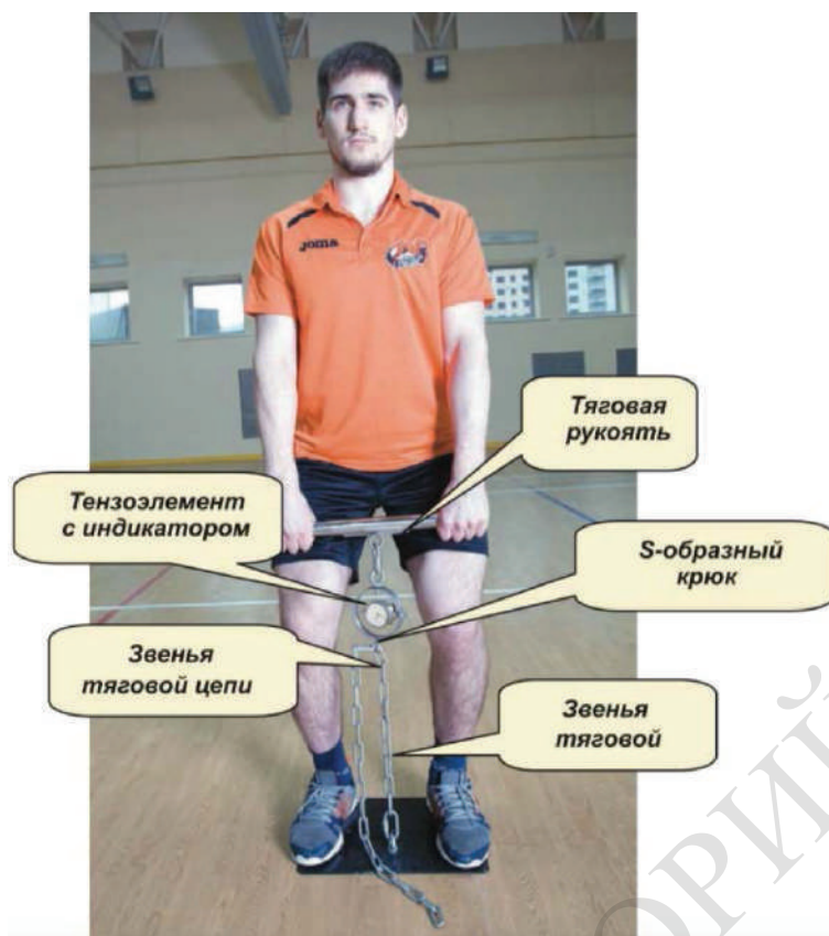
Рисунок 4. – Общий вид динамометрического устройства для определения силы тяги мышц разгибателей ног, туловища, стопы
