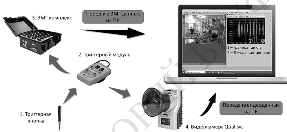
Рисунок 1 – Элементы осуществления синхронной регистрации ЭМГ и видео
