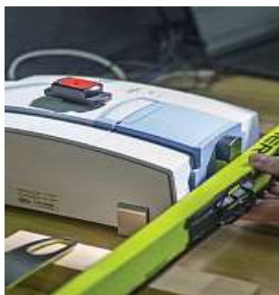
Рисунок 1 – Прибор для определения фтористого материала на скользящей поверхности лыж
