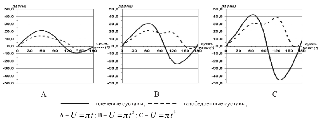
Рисунок 7 – Управляющие моменты сил в шарнирах модели при синтезе движения с одновременным уменьшением углов в проксимальном и дистальном шарнирах в условиях действия момента силы тяжести
