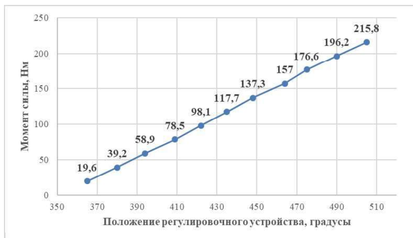
Рисунок 5 – Зависимость между величиной моментов силы на рычаге и значением поворота прижимного устройства
