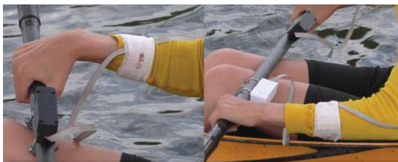
Рисунок 3 – Тензометрические датчики, закрепленные на весле спортсмена
