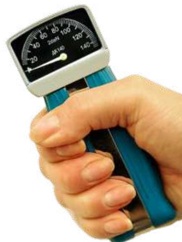
**Рисунок 1. – Прибор для измерения силы мышц кисти**
