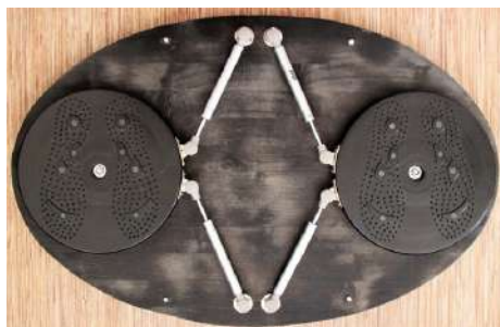
Рисунок 4. – Изокинетическое тренажерное устройство “Izodisk-2” для развития силы мышц обеспечивающих вращение ног (вид сверху)
