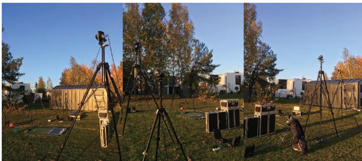
Рисунок 1 – Расположение камер аппаратно-программных комплексов оптического захвата движений Qualisys
