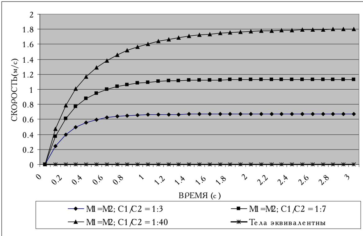
Рисунок 3 – Зависимость скорости ОЦМ системы от времени для различных соотношений коэффициентов сопротивления
