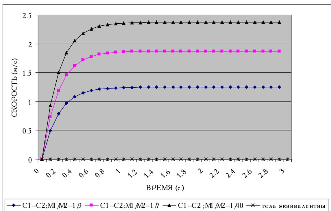
Рисунок 2 – Зависимость скорости ОЦМ системы от времени для различных соотношений масс взаимодействующих тел
