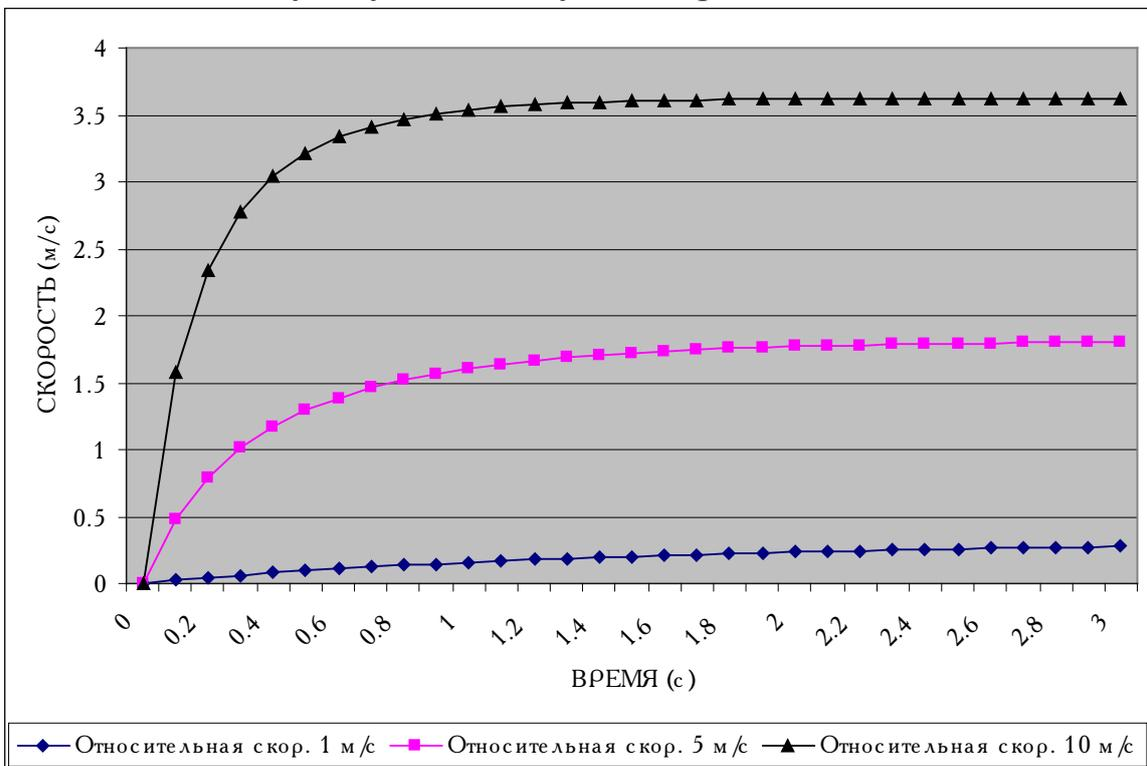
Рисунок 1 – Зависимость скорости перемещения ОЦМ системы от времени при различных значениях относительной скорости тел
