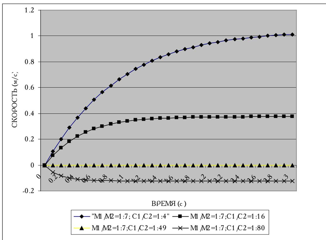
Рисунок 4 – Динамика изменения скорости ОЦМ системы при неограниченном увеличении коэффициента сопротивления одного из тел
