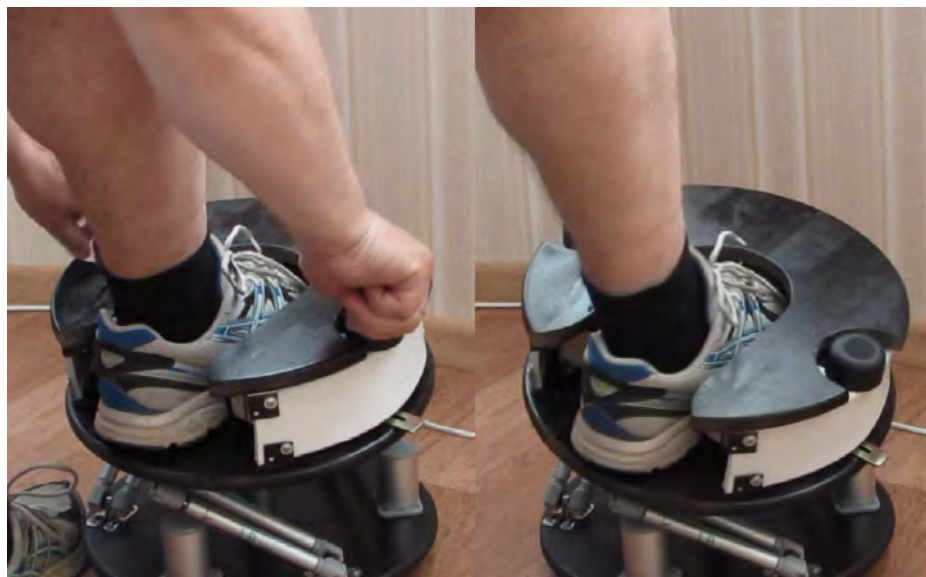
Рисунок 8. – Использование тренажерного устройства для развития силы мышц и реабилитации голеностопного сустава
