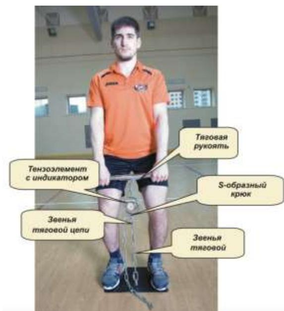
Рисунок 16 – Общий вид динамометрического устройства для определения силы тяги мышц разгибателей ног, туловища, стопы
