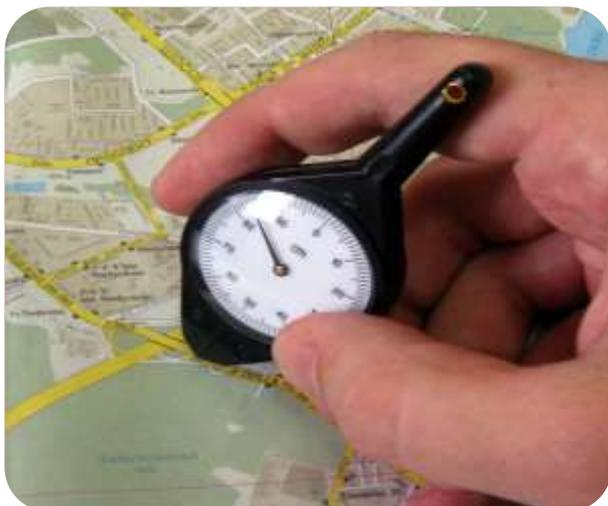
**Рисунок 93 – Механический курвиметр.** На шкале показывает расстояние (в сантиметрах), которое «проехало» зубчатое колесико по линии карты.
