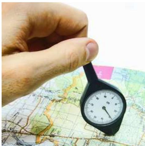
**Рисунок 36 – Механический курвиметр**
