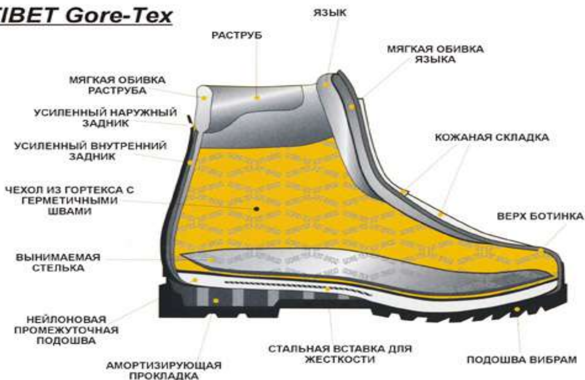
Рисунок 8.4 – Структура трекинговой обуви (рисунок с интернет сайта http://www.lasportiva.com.ua/ )
