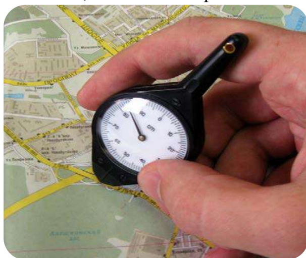
Рисунок 11.9 – Механический курвиметр. На шкале показывает расстояние (в сантиметрах), которое «проехало» зубчатое колесико по линии карты.
